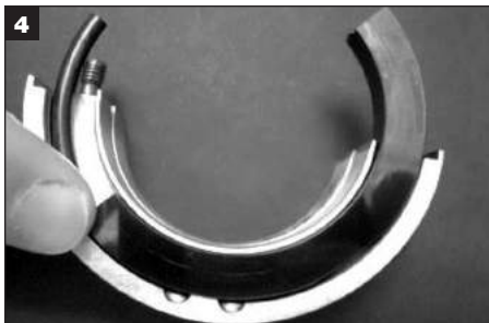
4 Déposez les moitiés usées de face tournante en poussant sur l'extrémité de la face et en la faisant glisser hors de la moitié de manchon tournant.
